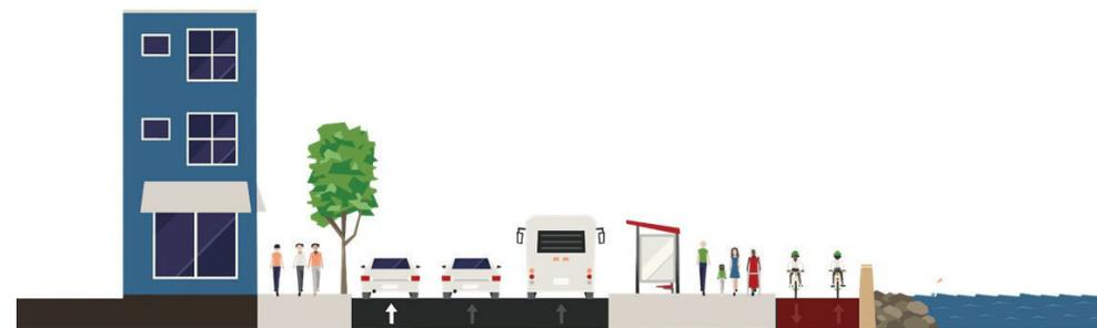
Figura 36: Seção da Av. Beira-Rio - Trecho 2 com ponto de ônibus e ciclovia à direita dos pedestres
