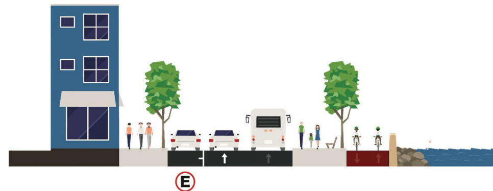
Figura 30: Seção da Av. Beira-Rio - Trecho 1 com estacionamento à esquerda e ciclovia à direita dos pedestres Fonte: Produção Logit - www.streetmix.net
