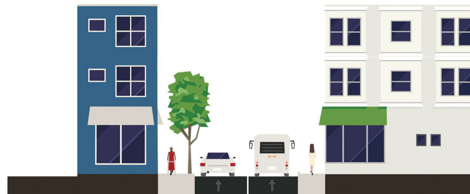
Figura 47: Seção da via da Rua Siqueira Lima com faixa preferencial para ônibus Fonte: Produção SEMDURB - www.streetmix.net
