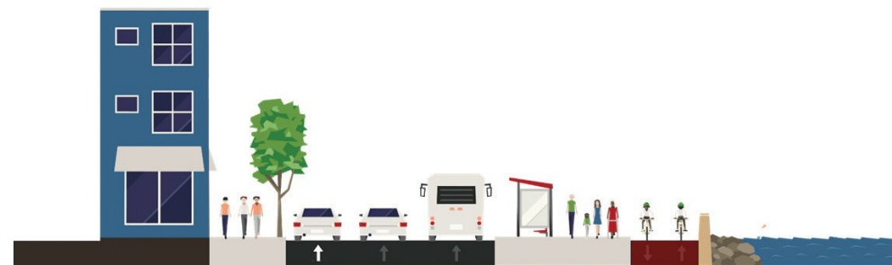
Figura 36: Seção da Av. Beira-Rio - Trecho 2 com ponto de ônibus e ciclovia à direita dos pedestres Fonte: Produção Logit - www.streetmix.net
