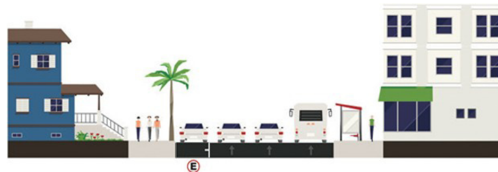
Figura 50: Seção da Rua Vinte e Cinco de Março - Trecho 1 com estacionamento à esquerda e ponto de ônibus Fonte: Produção Logit - www.streetmix.net
